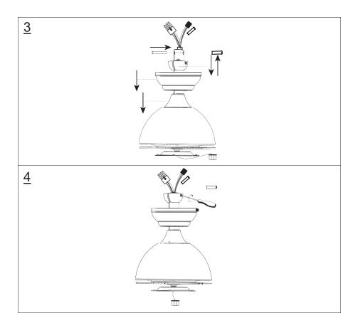
Schritt 2 – Deckenhalterung und Lüfterelement installieren
