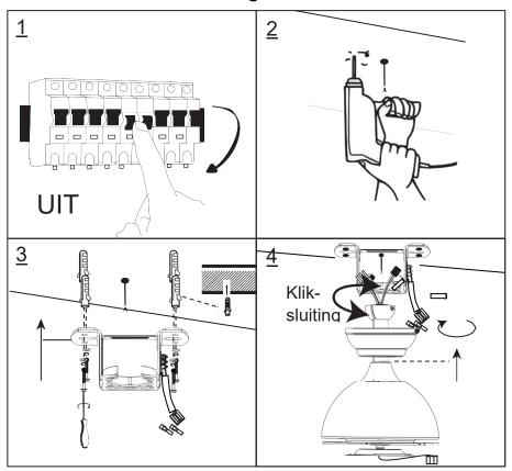
Schritt 3 – Platzieren Sie den Empfänger in der Deckenhalterung und verkabeln Sie ihn
